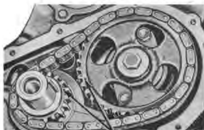
FIG. 51—Aligning Timing Marks
